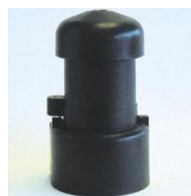
Tête d'échantillonnage omnidirectionnel amovible en fonction de la fraction conventionnelle à échantillonner
